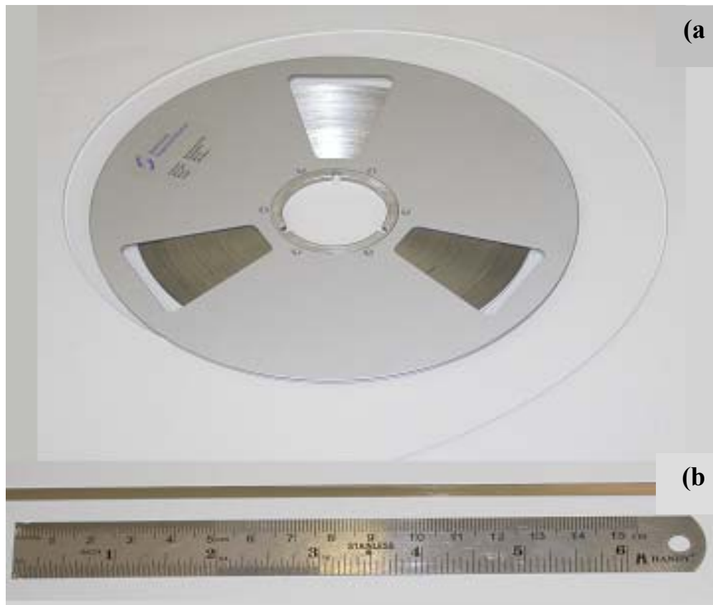
תמונה 11. (a) חוט מוליך-על מסחרי BSCCO-2223 באורך של 200 m המלופף על גליל. החוט מתוצרת ASC. (b) קטע חוט מוליך-על מסחרי BSCCO-2223 עליו בוצעו המדידות.
